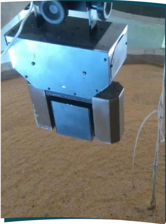
Sistema de aeração e termometria digitais em todos os silos, com acionamento automático e remoto on-line pela internet. Acesso instantâneo e pela internet das quantidades de grãos em cada silo de sistema com robô, que faz a medição e permite que seja feito monitoramento à distância por computador ou celular.
